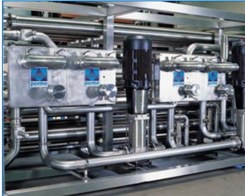
Unité de bi-osmose inverse de 54 m 3 /h - Série spéciale avec tableau de pontage pour CIP
